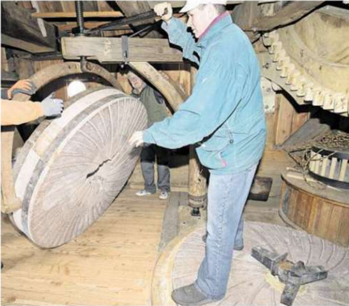
Unter Aufsicht von Kursleiter Rüdiger Hagen wird der tonnenschwere obere Mahlstein mithilfe des Steinkrans angehoben.
